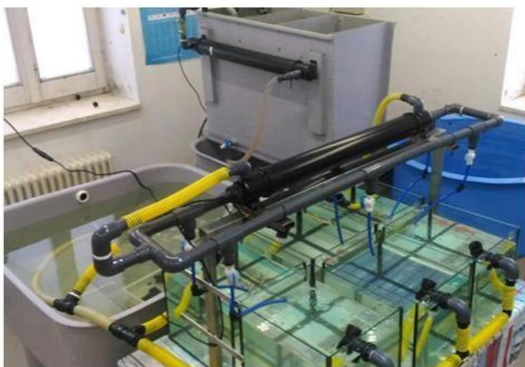
**Fig. 1** Sistema di depurazione sperimentale molluschi bivalvi
